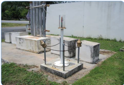
เครื่องวัดปริมาณน้ำฝนติดตั้งที่เทศบาลตำบลสระลงเรือ อำเภอยะหา
