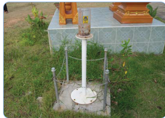
เครื่องวัดปริมาณน้ำฝนติดตั้งที่ อบต.สมเด็จพระเจริญ อำเภอนองปรี
